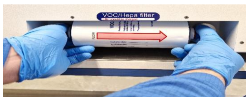
Obrázok 12.2 Postup vkladania a vyberania filtra VOC/HEPA
