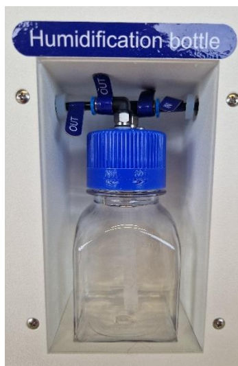
Obrázok 22.1 Pripojenie hadičiek na zvlhčovacej fľaši a viackomorovom inkubátore IVF Mini MIRI® Humidity
