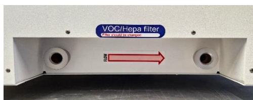
Obrázok 12.1 Prietoková šípka na inkubátore Mini MIRI® Dry multiroom IVF
